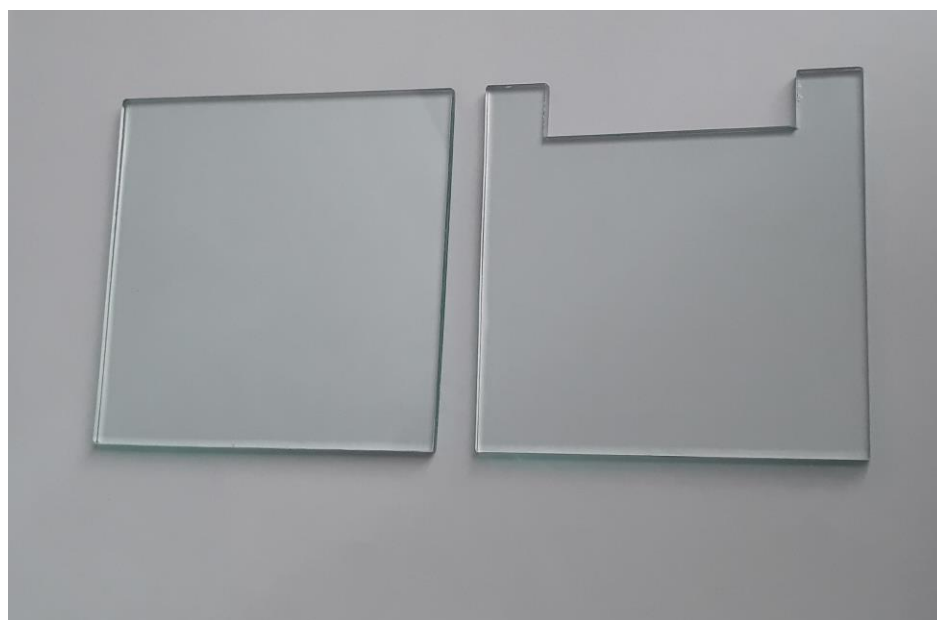
شکل 2. پلیت‌های ساده و U شکل مربوط به کستینگ یک ژل در الکتروفورز عمودی
