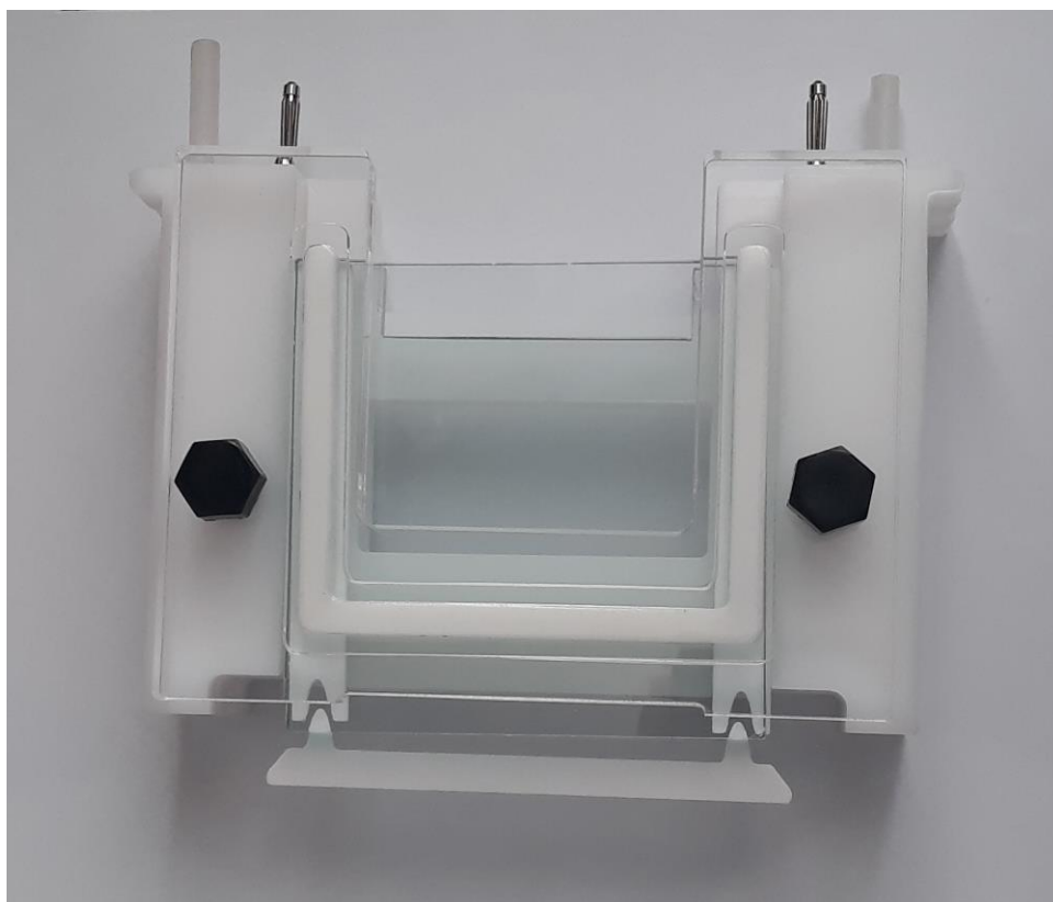
شکل 10. حالا اسپیسر پایین را در محل های اسپیسر پایین جای گذاری کنید.
