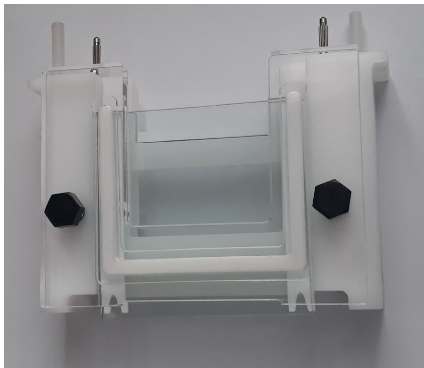
شکل 8. بخش نگهدارنده واحد رانینگ ژل را مطابق شکل بر روی دستگاه قرار داده و پیچ های آن را محکم نمایید.
